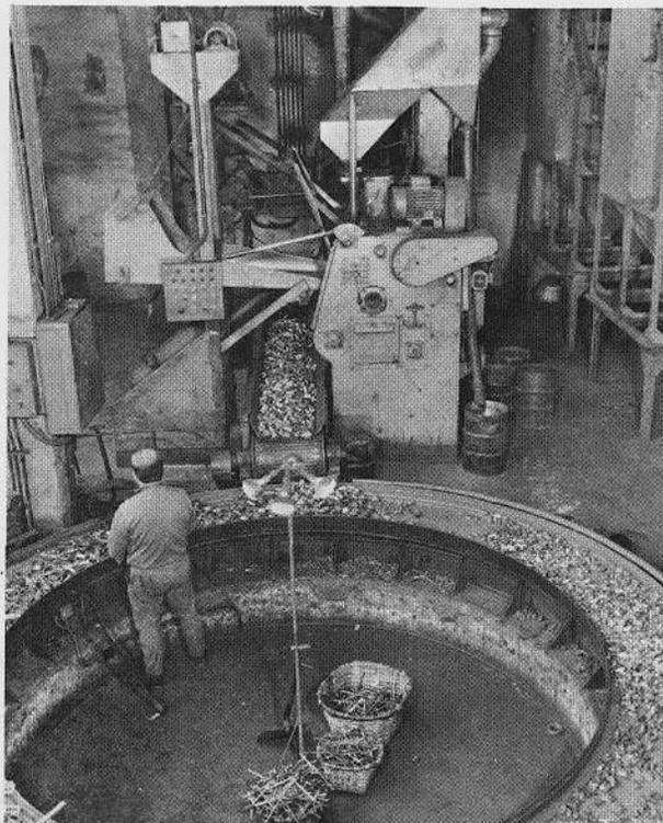
Salida de limpieza de piezas de una fundición de Alfa, de Eibar
